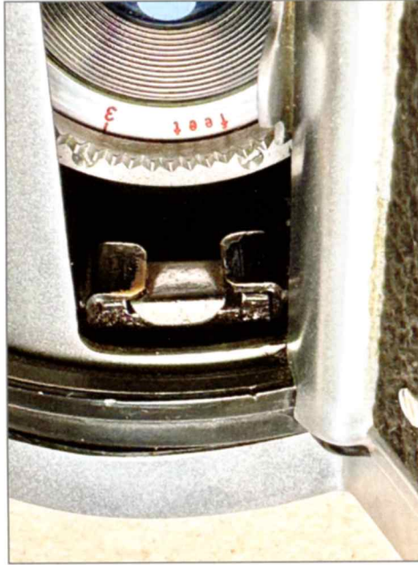
Abb. 7b: Zubehörschuh für Farbfilter
