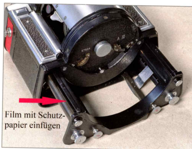
Abb. 9: nach Entfernen des Bodens kann der Filmhalter entnommen werden.
